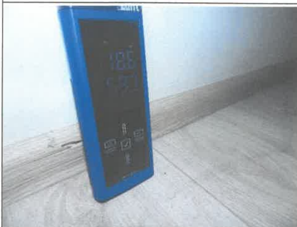
Fot. 04. Pomiar temperatury wraz z wilgotnością powietrza (pokój nr 1).
