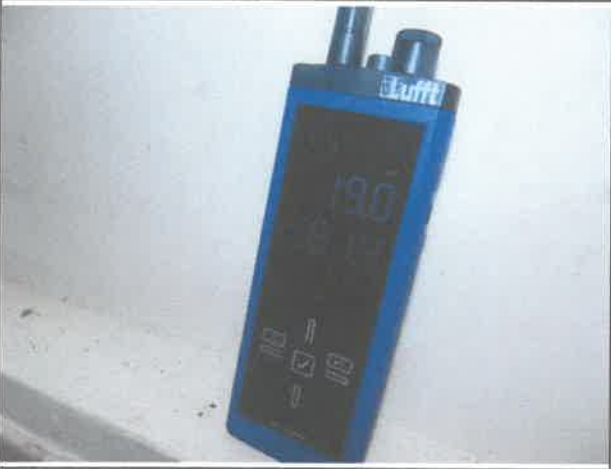
Fot. 07. Pomiar temperatury wraz z wilgotnością powietrza (kuchnia).
